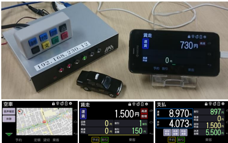
スマートタクシーメーター原理試作機（開発中）
